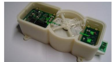
Alimentation DC-DC isolée pour gate driver (30kV)
