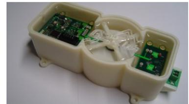
Alimentation DC-DC isolée pour gate driver (30kV)
